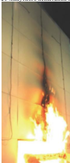
Окончание 30-минутного испытания по NFPA 285
